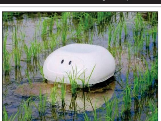
ram ağırlığında. Bu robot Global Mövqətəyinətə Sistemindən (GPS) istifadə edərək düzü tarlasında hərəkət edir. Robotun yaradılmasında məqsəd düzü istehsalı zamanı pestisidlərdən istifadənin karşısını almaqdır.
